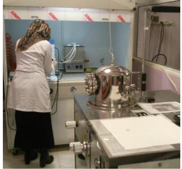
Silar tekniği ile kristal büyütme sistemi.
