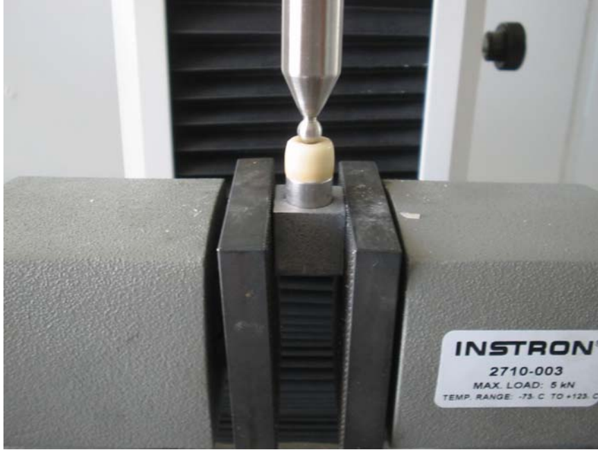
Şekil 3.13: Instron Universal Test Cihazında kırılma direnci testi
