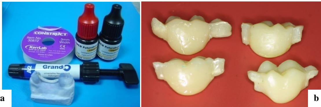
Şekil 3.10: a) Construct fiber altyapı ve kullanılan malzemeler, b) Construct-Grandio örnekler
