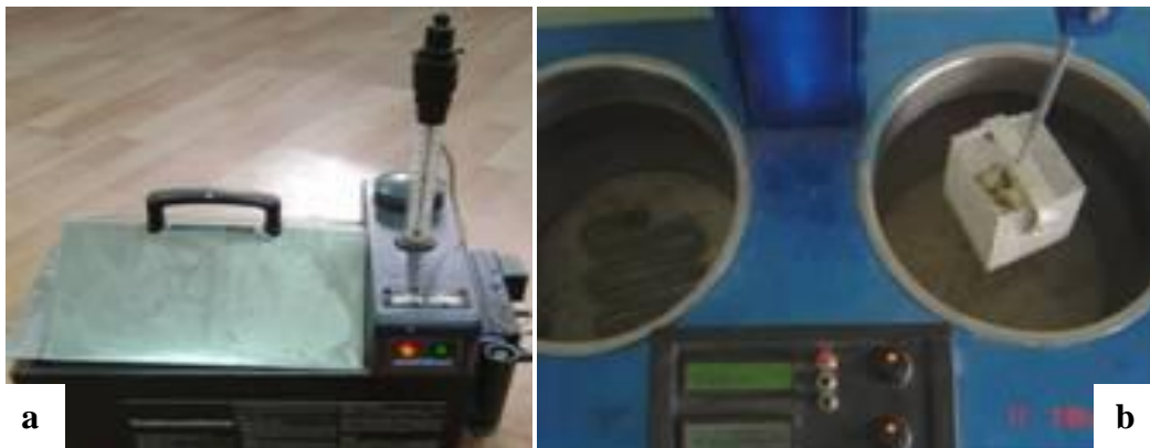
Şekil 3.16: a) 37°C' lik distile su banyosu, b) Termal siklus cihazı
