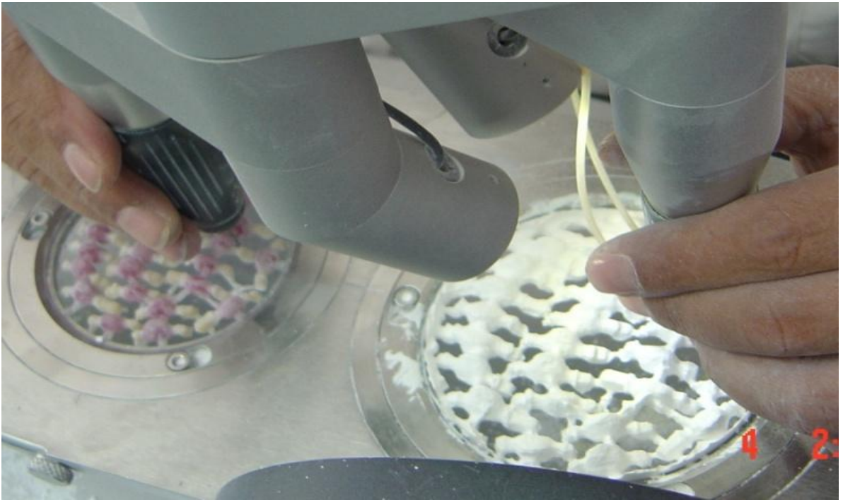
Şekil 3.13: Altyapıların zirkon bloktan freze edilmesi
