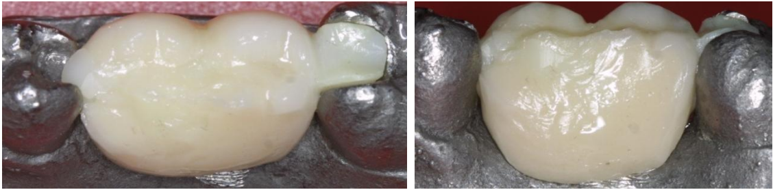
Şekil 4.5: Zirkonyum alt yapıli porselen örneklerde oluşan alt yapı kırılma tipi.
