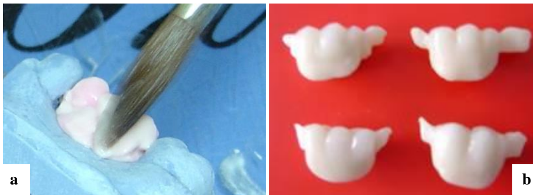
Şekil 3.14: a) Üst yapı porseleninin uygulanması, b) Hazırlanmış zirkonyum örnekler
